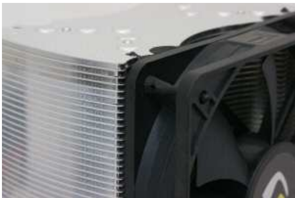
Krok 16: Poprawnie zamontowany wentylator
