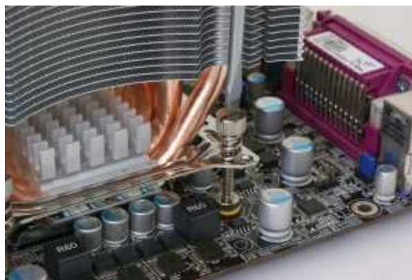
Krok 14: Dokręć wkrętkami nakrętki, aż poczujesz delikatny opór
