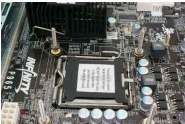
Krok 7: Użyj nakrętek by przymocować backplate na sztywno do płyty
