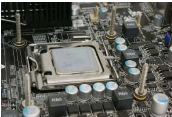
Krok 8: Posmaruj procesor pastą termoprzewodzącą
