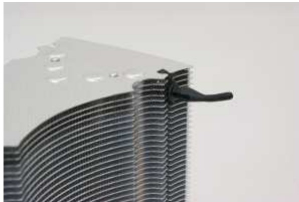
Krok 11: Poprawnie zastosowane mocowanie wentylatora
