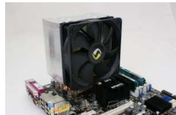
Krok 15: Naciągnij wentylator na gumowe kołki oraz podłącz go do płyty głównej
