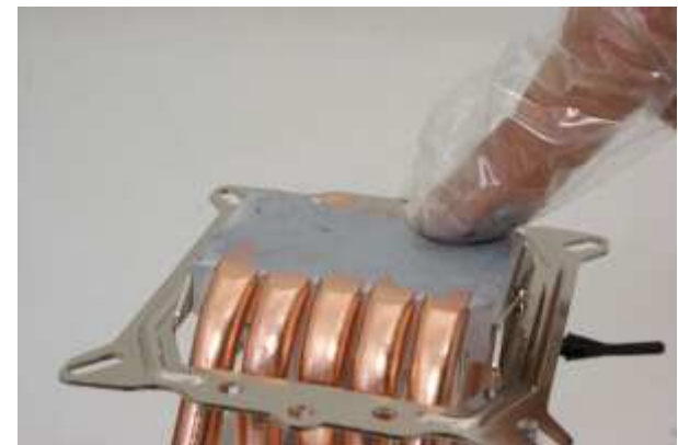
Krok 9: Posmaruj podstawę chłodzenia pastą termoprzewodzącą
